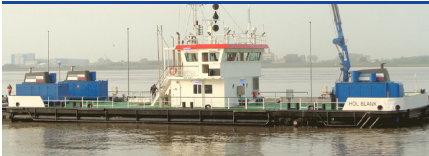
HOL BLANK - установка для нагнетания воды для порта Бремен/Бремерхафен, Права на иллюстрацию: компания bremenports GmbH & Co. KG»
