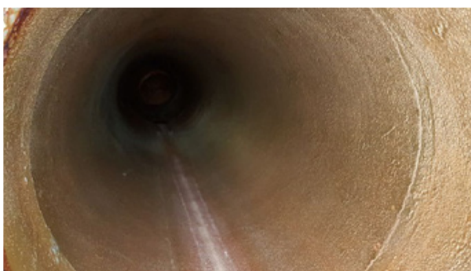
Напорная труба большого размера (номинальный диаметр 700 мм), внутреннее покрытие, после 10 лет эксплуатации – Права на иллюстрацию: компания «bremenports GmbH & Co. KG»
